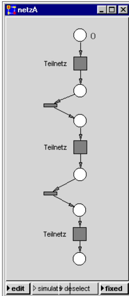
Im vorliegenden Fall könnte man die mehrfache Verwendung von "Teilnetz" natürlich auch durch Modellierung einer Schleife vermeiden. In allgemeineren Fällen, in denen der einzusetzende Modul z.B. auf verschiedenen Hierarchiestufen des Netzes verwendet werden
