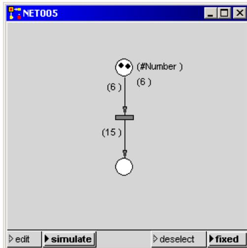
Wird nun statt einer Konstanten ein Variablenname am Eingangskonnektor angegeben, so wird der Wert des Markenattributs bei der Aktivierung der durch diese Beschriftung eingeführten Variablen zugeordnet. Im "Umkreis" einer Transition (d.h. bis zu den angrenzenden Stellen) sind diese Variablen als sogenannte "transitionslokale" Variablen bekannt.
