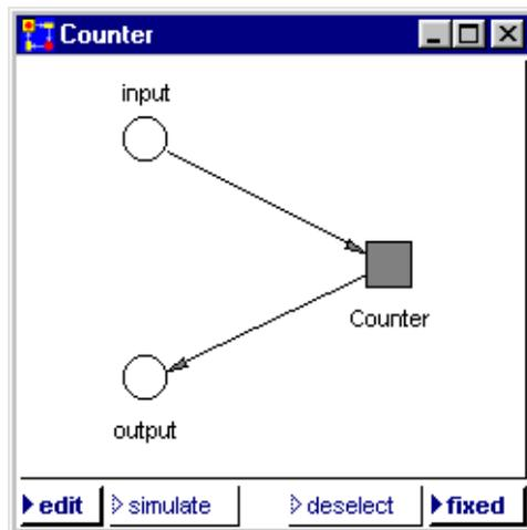
Es besteht aus drei einfachen Netzelementen: den Stellen 'input' und 'output', welche die Zahlen vor dem Eintritt und nach Verlassen des Moduls 'Counter' aufnehmen.
