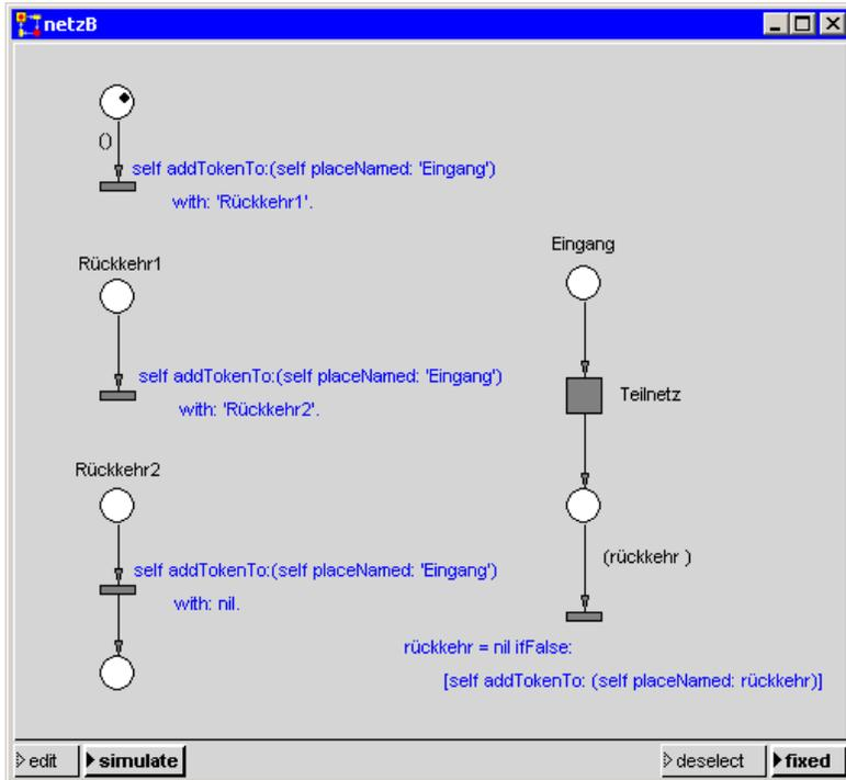
Das rechte Teilnetz wird durch Einlegen einer Marke in die Stelle "Eingang" beauftragt. Dabei ist als Argument die Stelle, in der das Ergebnis abgeliefert werden soll, anzugeben; im vorliegenden Fall werden die Stellen "Rückkehr1" und "Rückkehr2" verwendet. Die jeweilige Rückkehr-Stelle wird im Teilnetz über die Konnektorvariable "rückkehr" zur Ausgangs-Transition "Ausgang" gebracht.
