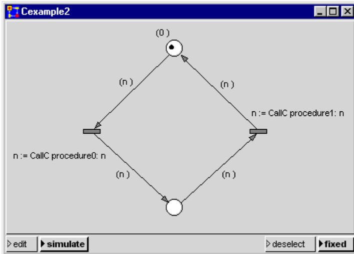
In der linken Transition wird über die Methode ‚procedure0:‘ eine zu erstellende C-Prozedur: ‚incrementValue‘ aufgerufen, welche den Wert von n inkrementiert und wieder an das Netz zurückgibt. Die rechte Transition ruft über die Botschaft ‚procedure1:‘ eine zu erstellende C-Prozedur ‚checkValue‘ auf, welche den Wert von n ggf. zurücksetzt.
