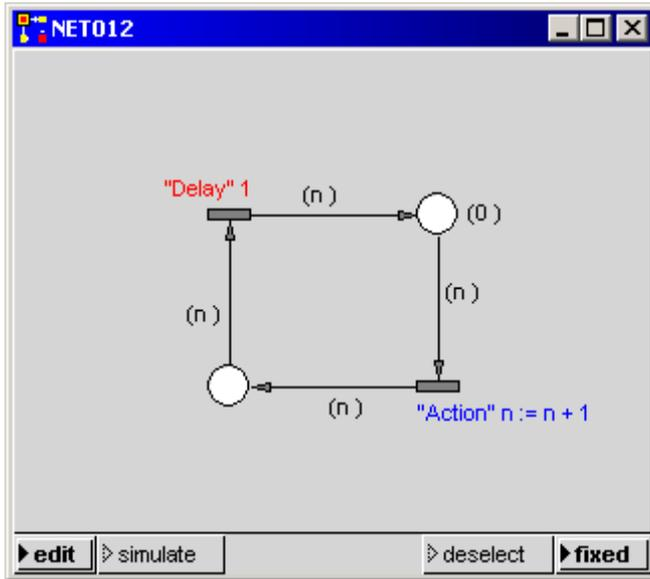
Können mehrere Transitionen zu demselben Zeitpunkt feuern, so ist die Reihenfolge nicht definiert, d.h. zufällig. Dabei können unerwünschte Effekte auftreten. Beispielsweise müssen bei einem Materialflußsystem die gleichzeitig ankommende Werkstücke zeitlos sortiert werden. Ein "Warten" am Sortierplatz muß gegebenenfalls erzwungen werden (z.B. mit sehr kleinen Wartezeiten).
