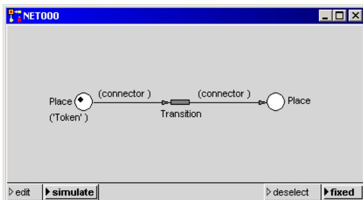
Konnektorattribute an den Ausgangskonnektoren werden zur Erzeugung von Ausgangsmarken verwendet (diese werden immer bei Feuern erzeugt). Beim Erzeugen der Ausgangsmarken an Ausgangskonnektoren mit Variablenbeschriftung, wird der Wert der transitionslokalen Variablen übernommen. Bei Variablen werden den Markenattributen die Werte der transitionslokalen Variablen zugewiesen; bei Konstanten werden Marken mit konstanten Attributen erzeugt.
