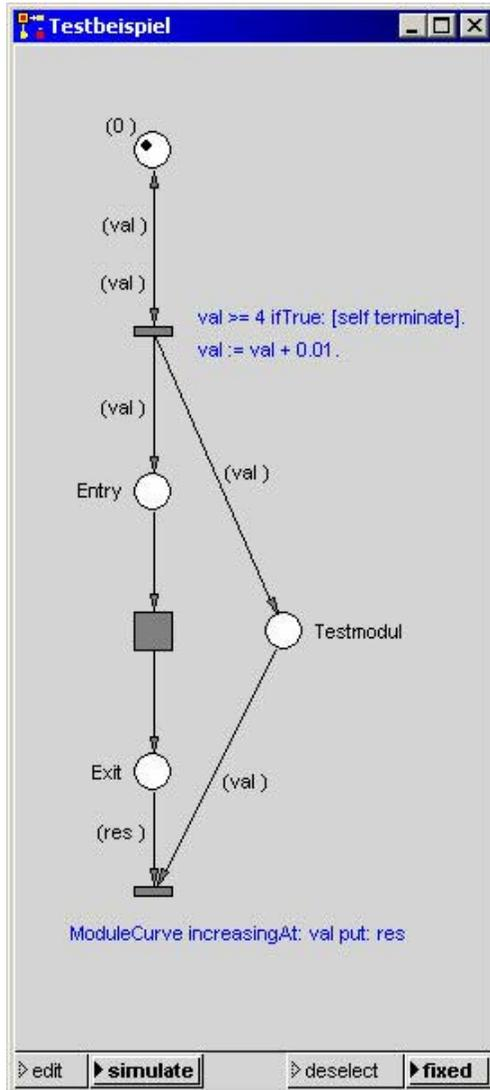
In die Stelle oben wird eine Initialmarke eingelegt, mit der die Berechnung der Kurve gestartet wird. Untersucht wird die Ergebnis-kurve im Intervall 0 bis 4. Dieses Intervall wird man, wenn keine Beschreibung zum Modul vorliegt, experimentell ermitteln, z.B. indem man einen größeren Bereich betrachtet und bei der Ausgabe-kurve ggf. die Parameteroption „automatic scaling“ einschaltet.
