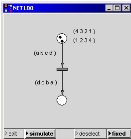
Eine Transition mit Eingangskonnektoren, welche mit gleichen Variablenamen versehen sind, kann nur feuern, wenn die den Variablen zugeordneten Werte gleich sind (Matching).
