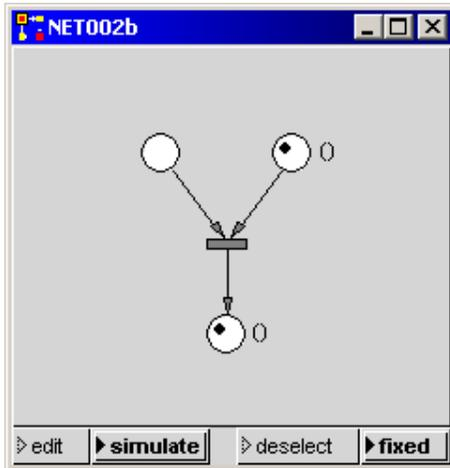
Beispiel: In einer Produktion werden zwei Teile zusammengefügt und ergeben ein einzelnes drittes Teil.
