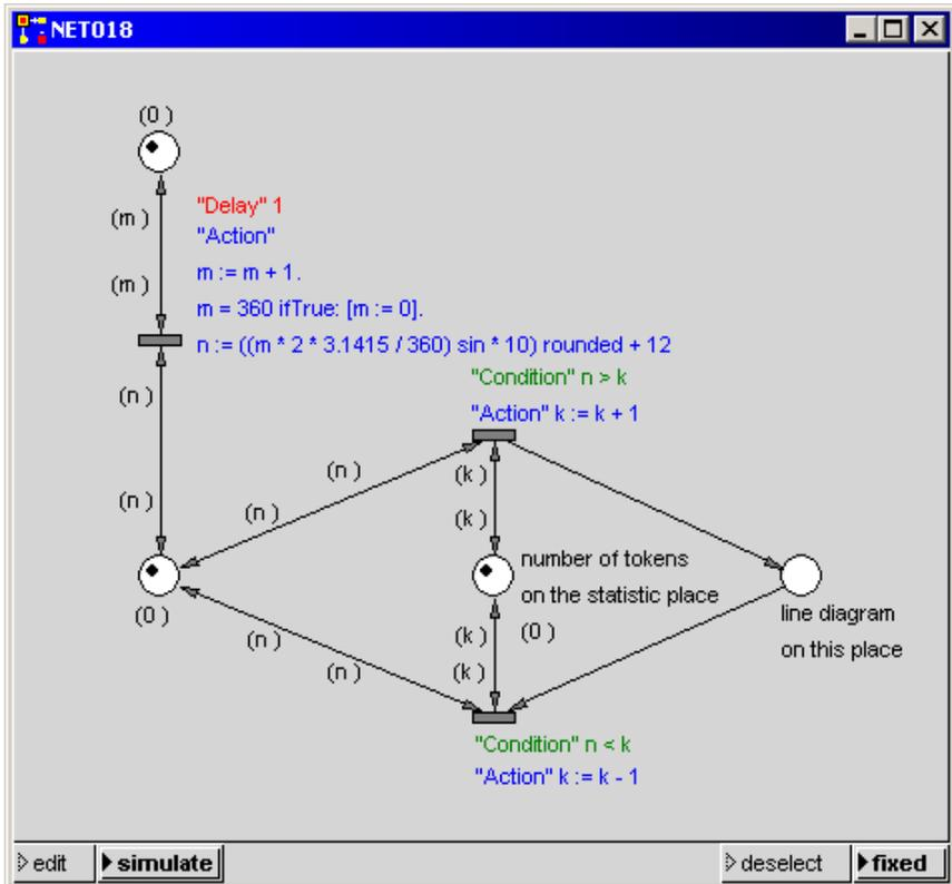
Das Liniendiagramm zeigt, für jeden Zeitpunkt (xAchse) die Anzahl der Marken (yAchse), die sich auf dem Platz befinden, an (Sinus).
