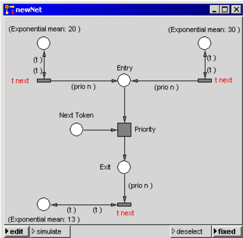
Dabei wurden auch die Attribute der Konnektoren ( $prio\ n$ ) eingesetzt. Als Date  $n$  wird die Objektnummer verwendet, die, wie die nächste Abbildung zeigt, bei Eintreffen eines Objekt vergeben wird und im Initialisierungscode auf 0 gesetzt wird. Die Priorität des häufiger eintreffenden Objekttyps wird niedriger gesetzt.
