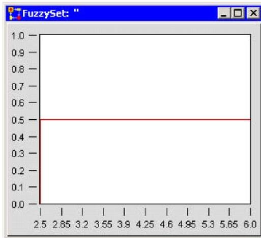
Zur Berechnung der Bremsstärke sind die beiden in den vorangegangenen Abbildungen dargestellten Fuzzy-Sets mit and: zu verknüpfen. Das liefert den in der folgenden Abbildung dargestellten Fuzzy-Set:
