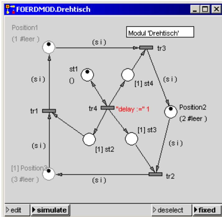
Da der Drehtisch die Positionen in einer Zeiteinheit weiterschaltet, feuert die Transition tr4 einmal pro Zeiteinheit und legt auf den Stellen st1 bis st4 jeweils eine Marke ab. Die in st1 abgelegte Marke plant das Feuern zum nächsten Zeitpunkt ein. Bis dahin feuern die drei Transition tr1 bis tr3, da in allen Eingangsstellen dieser Transitionen jeweils eine Marke liegt, und transportieren die in den drei Positionen liegenden Marken in die jeweils nächste Position.
