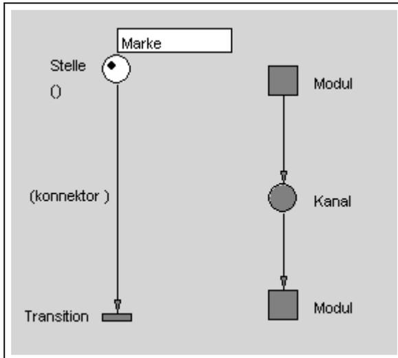
Stellen sind passive Elemente, Transitionen aktive Elemente eines Petri-Netzes. Eine Marke "wandert" immer von einer Stelle über eine Transition zur nächsten Stelle. Transitionen wechseln sich im Netz immer mit Stellen ab.
