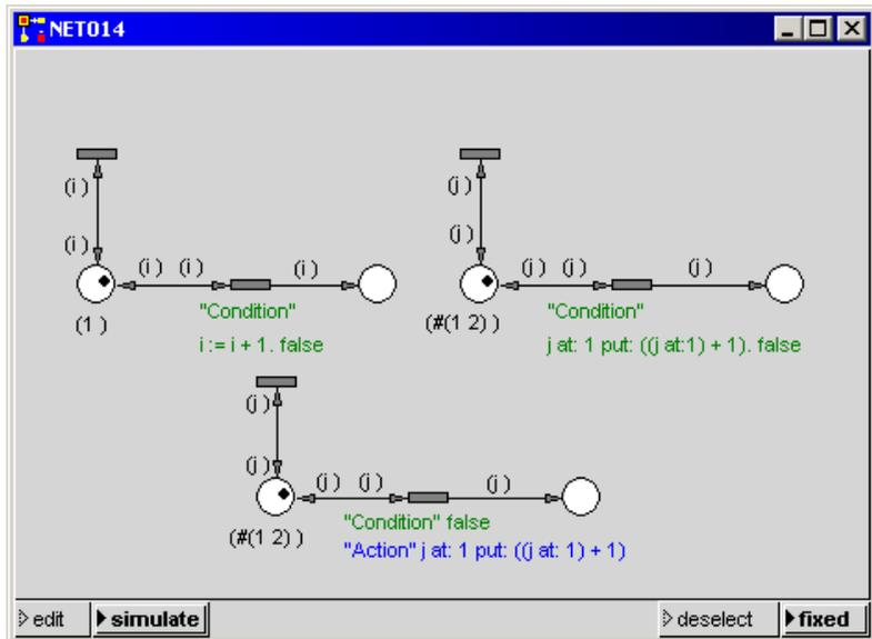
Bei Transitionen, die Manipulationen an Objekten der Klassen Array, Association, Dictionary, OrderedCollection und Set vornehmen, arbeitet Smalltalk nicht mit einer Kopie dieses Objekts, sondern direkt mit diesem. Deshalb entstehen gelegentlich unerwünschte Effekte, die durch geeignete Programmierung (meist Kopieren des Objekts) vermieden werden können.
