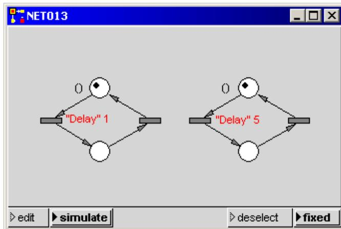
Eine Marke im linken Netz läuft fünf Runden bis die erste Transition im rechten Netz feuert.
