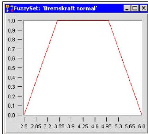
Unter Verwendung der im 2. Schritt berechneten Kompatibilität der linken Seite mit Wert 0.5 wird über dem gleichen Gültigkeitsbereich der in der folgenden Abbildung dargestellte Fuzzy-Array mit folgenden Punkten gebildet:
