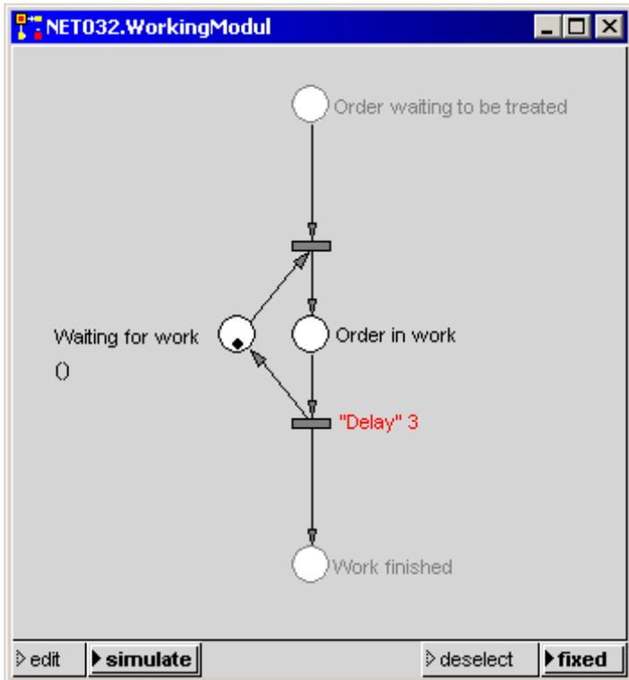
Durch die Anzahl der Marken, mit der die Stelle 'Waiting for work' initialisiert wird, kann die Maximalzahl der gleichzeitigen Bearbeitungen im Modul eingestellt werden (z.B. Maximalzahl der BatchProzesse).
